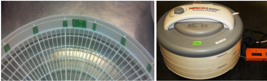
Fig.1: Izquierda: Bandeja del deshidratador de alimentos nivelada; derecha: comprobación de la temperatura con un termómetro de sonda.
